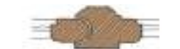
XIX e /début XX e : Montant à mouton et gueule de loup
