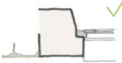
^ Enduit en affleurement
