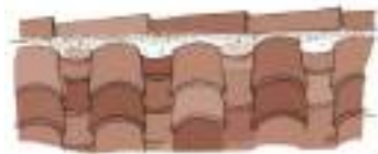
^ faîtage de tuiles scellées au mortier
