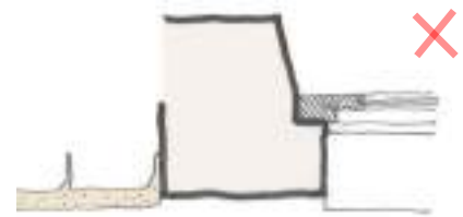
^ Enduit en surépaisseur par rapport à la pierre de taille
